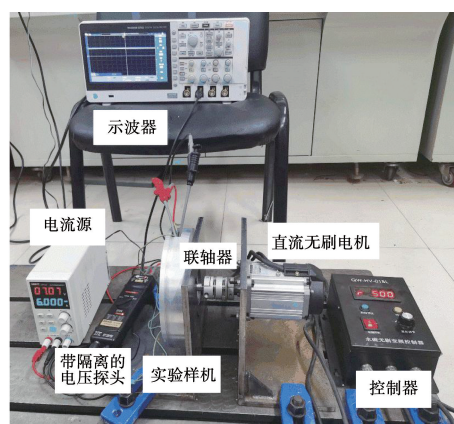
图10 动态实验装置总成
